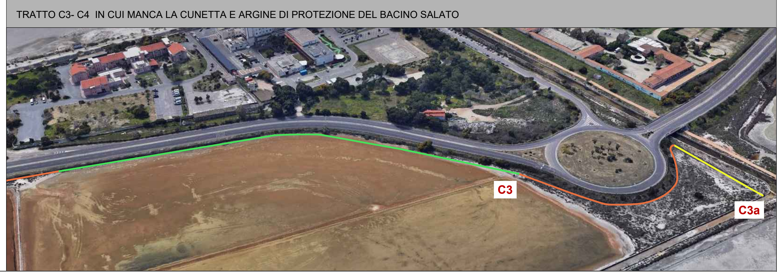
TRATTO C3-C4 IN CUI MANCA LA CUNETTA E ARGINE DI PROTEZIONE DEL BACINO SALATO
